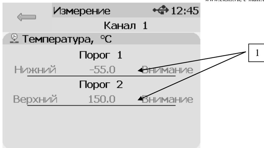
Рисунок 6.6 Экран настройки пороговых значений второго канала измерения
