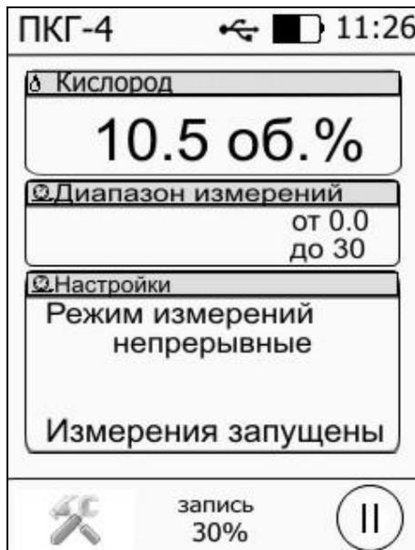
Рисунок 5.2 – Экран включенных непрерывных измерений
