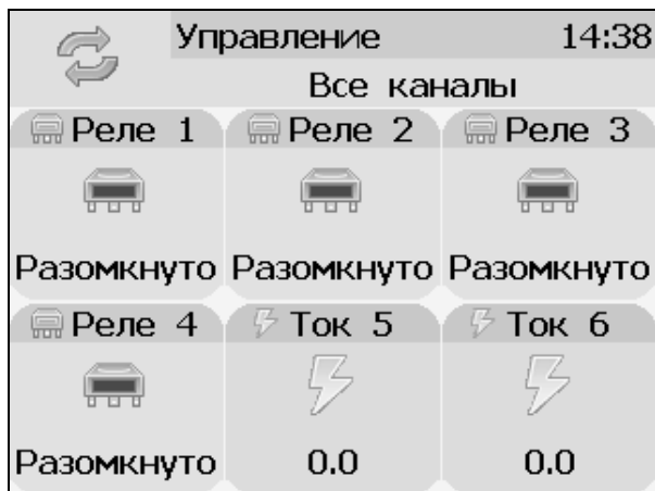
Рисунок 6.10 Вид экрана состояния каналов управления
