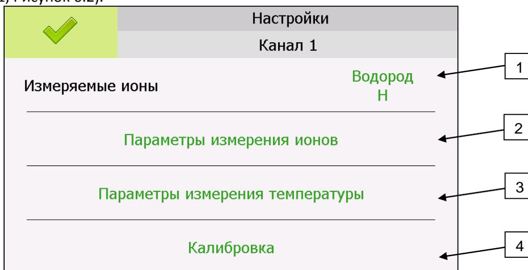
Рисунок 6.4 Экран настройки канала измерения
