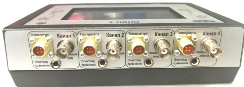
Рисунок 3.3 Вид верхней боковой панели ПИОН-5 /X (на примере четырёхканального исполнения)
