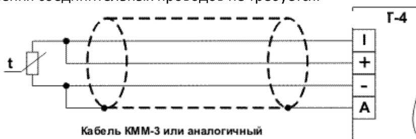
Рисунок 3.5 Четырехпроводная схема
