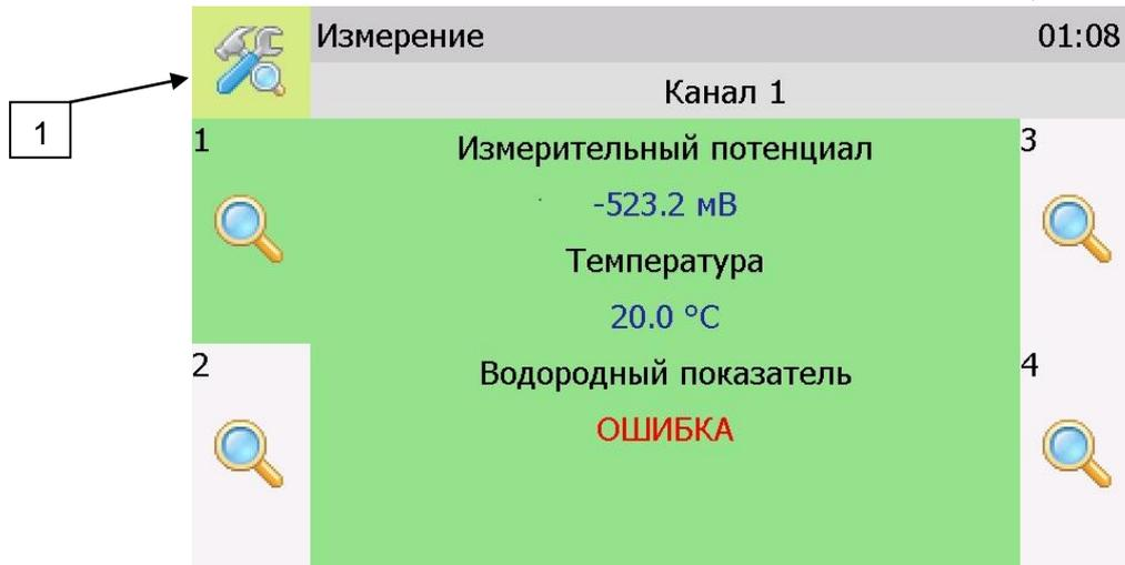
Рисунок 6.2 Экран канала измерения
