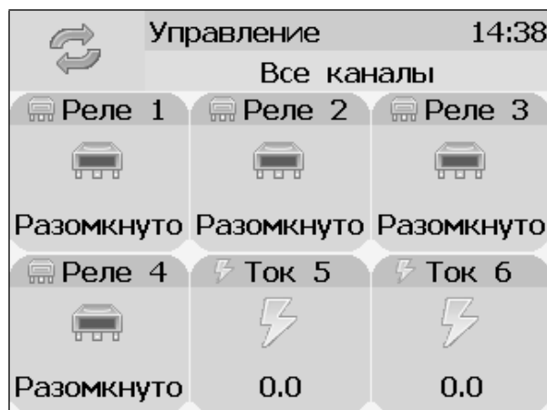
Рисунок 6.29 Вид экрана состояния каналов управления
