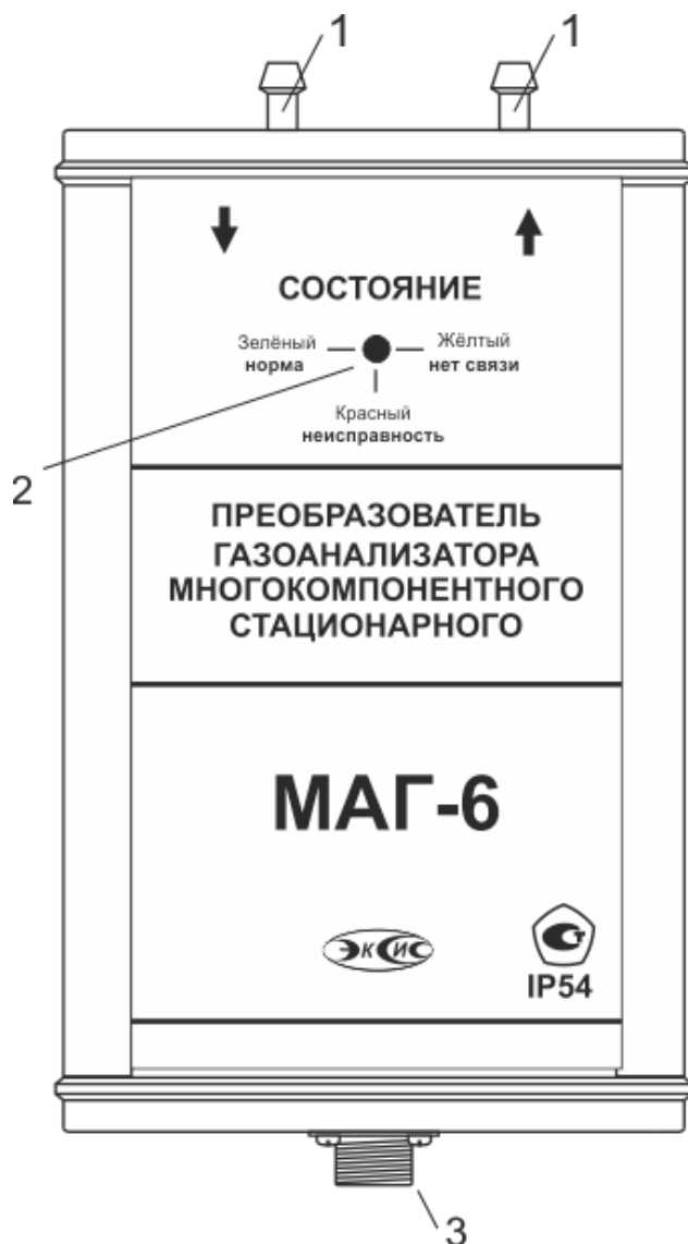
Рисунок 3.7 Измерительный преобразователь с побудителем расхода МАГ-6 до четырех газов
