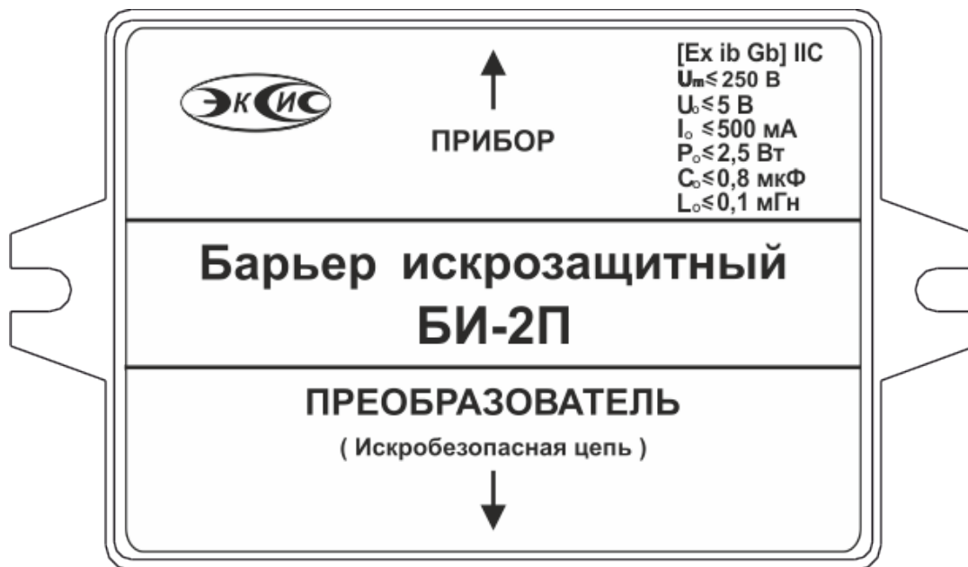
Рисунок 3.17 Барьер искрозащиты БИ-2П
