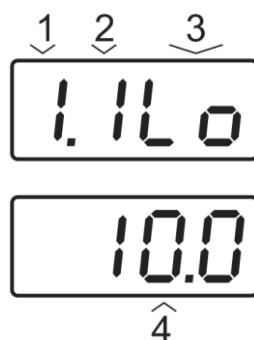
Рисунок 6.8. Расшифровка поля настройки порогов
