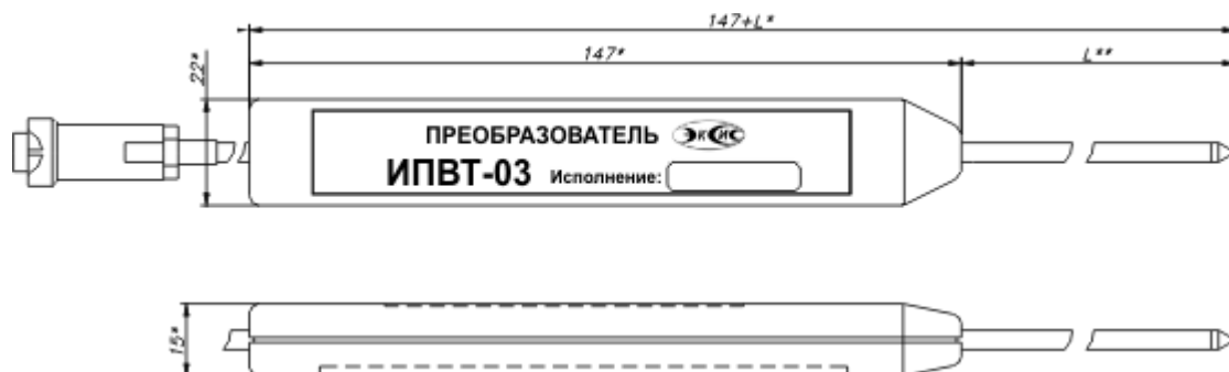
Рисунок В4 Измерительный преобразователь ИПВТ-03-05
