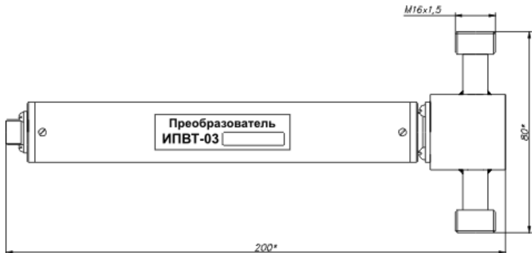
Рисунок В2 Измерительный преобразователь ИПВТ-03-03
