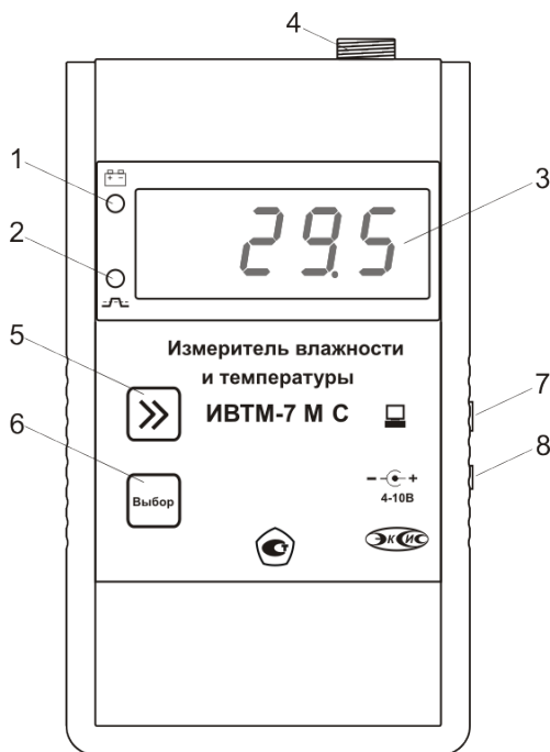
Рисунок 3.1 Внешний вид измерительного блока ИВТМ-7 М С
