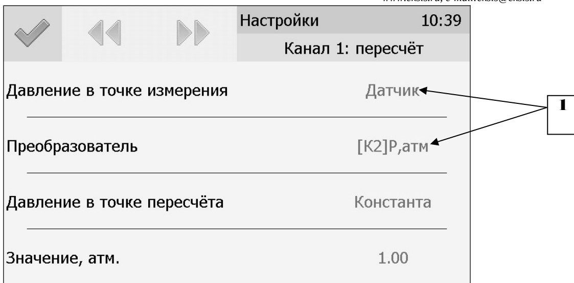
Рисунок 6.13 Настройка параметров пересчета влажности.
