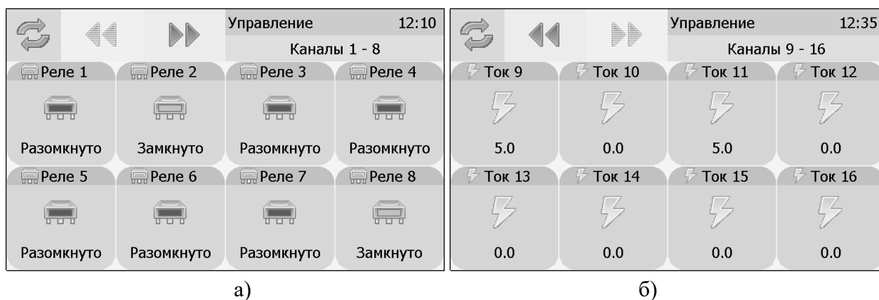
Рисунок 6.15 Вид экрана состояния каналов управления (а – каналы «реле», б – каналы «ток»)
