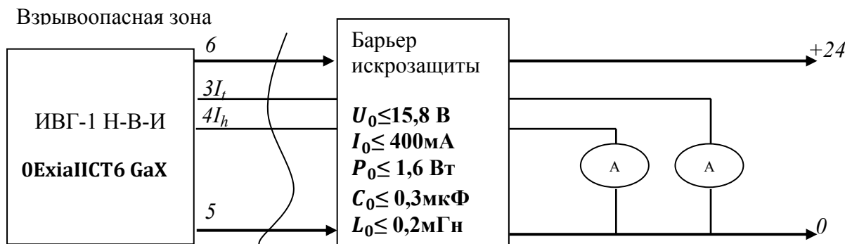
Рисунок 4.1–Схема подключения ИВГ-1 Н-(В)
