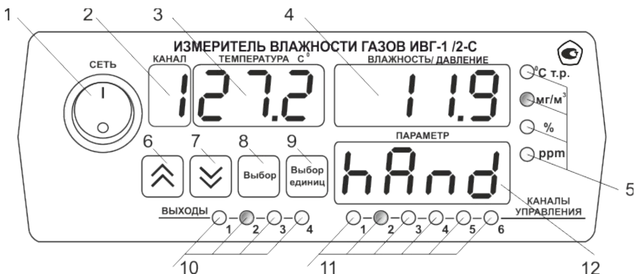
Рисунок 3.1 Вид лицевой панели прибора: ИВГ-1 /1-В-С-2А, ИВГ-1 /1-В-С-4Р-2А, ИВГ-1 /2-В-С-4Р-2А (сверху вниз).
