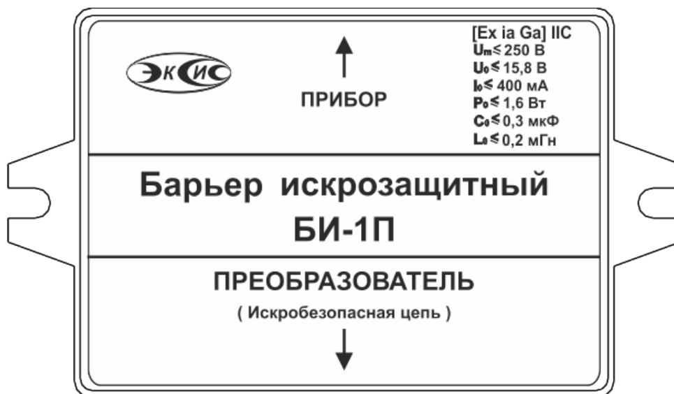
Рисунок 3.19 Барьер искрозащиты БИ-1П
