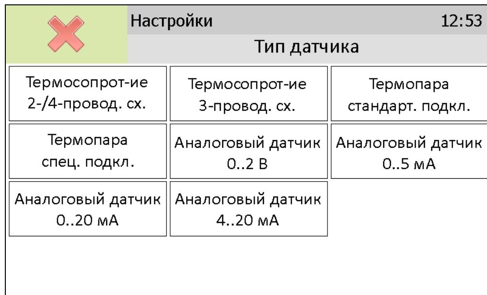
Рисунок 6.22 Выбор типа датчика.
