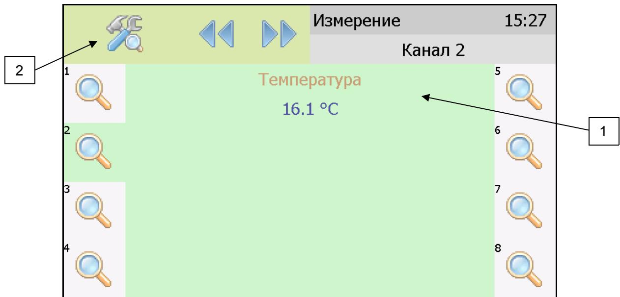
Рисунок 6.10 Вызов экрана настройки второго канала измерения
