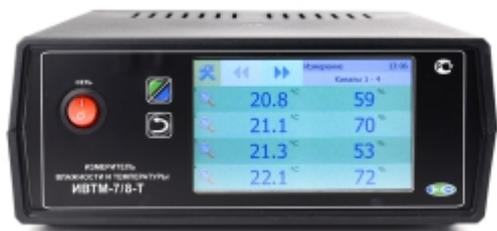
Лицевая панель измерительных блоков с 8 каналами
