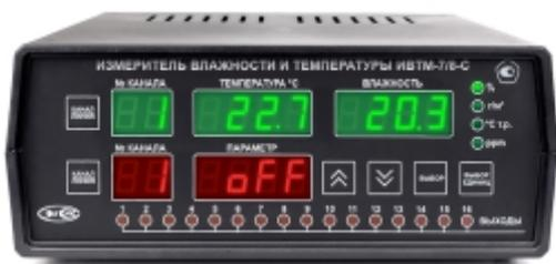
Лицевая панель измерительных блоков с 8 каналами
