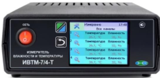
Лицевая панель измерительных блоков с 4 каналами
