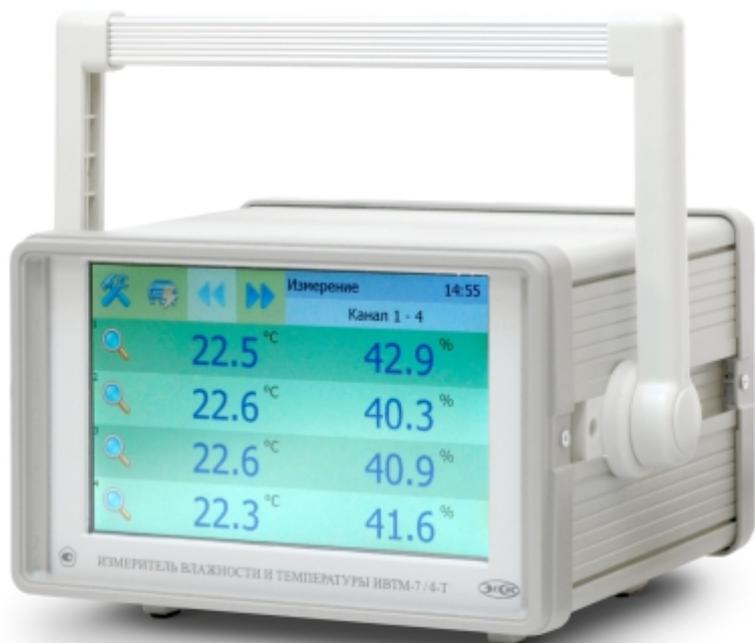
Корпус настольного исполнения с сенсорным графическим TFT-дисплеем 7" с 4, 8 или 16 каналами. Наличие до шестнадцати встроенных устройств коммутации (реле) для управления внешними исполнительными устройствами и до шестнадцати токовых выходов 4..20 (0..5, 0..20) мА. Объем памяти статистики до 512 тысяч точек записи. Возможность объединения приборов в измерительную сеть. Поддержка протокола Modbus RTU и Modbus TCP. Питание 220 В. Несколько интерфейсов связи: RS-232, RS-485, USB, Ethernet.
