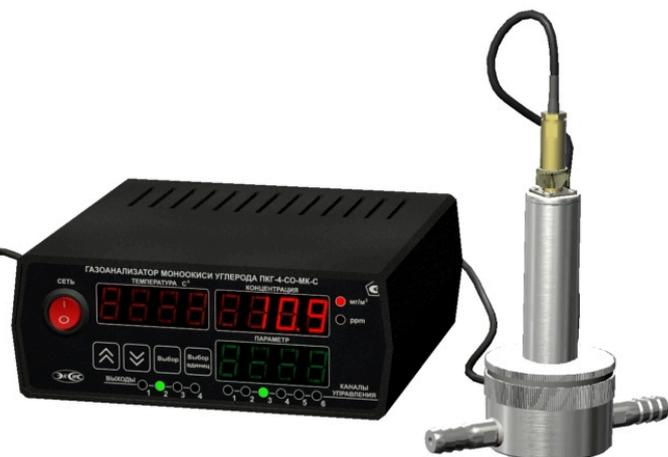
Преобразователь концентрации монооксида углерода может быть выполнен в металлическом корпусе «**микрофон**» для определения концентрации газа в воздухе рабочей зоны. Другой вариант исполнения измерительного преобразователя — в виде металлической **проточной камеры** - предназначен для измерения концентрации монооксида углерода в баллонах и газовых магистралях.
