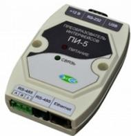
ПИ-5 предназначен для передачи информации между интерфейсами Ethernet, USB ↔ RS-232, RS-485 посредством эмуляции последовательного COM-порта. Используется для объединения устройств в информационную сеть и удаленной связи персонального компьютера с измерительными устройствами.
