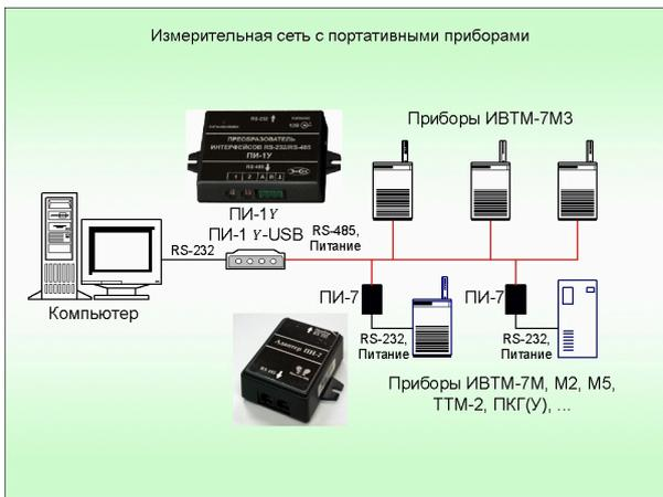
Для реализации сети используется преобразователь интерфейсов. Основу сети составляют портативные приборы ИВТМ-7 М3, которые подключаются непосредственно к интерфейсу RS-485. Питание приборов осуществляется от преобразователя.
