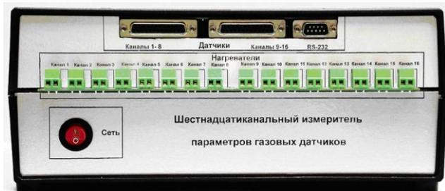
Предназначен для проведения исследований характеристик полупроводниковых сенсоров различных марок и типов, а также тестовых структур; для аттестации газовых сенсоров при работе в составе измерительной системы.
