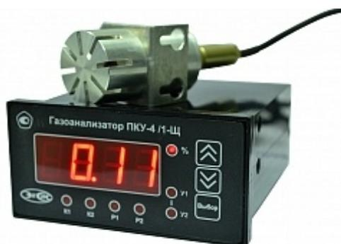
Прибор ПКУ-4 /1-Щ предназначен для измерения концентрации диоксида углерода (углекислого газа) и комплектуется выносными преобразователями ИПДУ-03 или ИПДУ-04, подключаемыми с помощью соединительного
