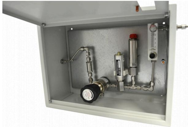
**Система подготовки газа СПГ-Н, предназначена для измерения температуры точки росы сжатых газов при атмосферном давлении, с понижением текущего.**
