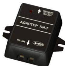
Предназначен для подключения устройств с RS-232 интерфейсом в RS-485 сеть. Питание преобразователя осуществляется через RS-485 порт с разъемом RJ-11. Разработан для работы с преобразователями интерфейсов ПИ-1У и ПИ-1У-USB.
