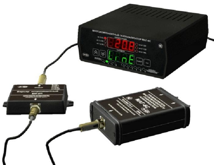
Прибор МАГ-6С-Х предназначен для непрерывного (круглосуточного) измерения и регистрации концентрации до четырёх газов одновременно. В зависимости от исполнения прибор применяется для измерения концентрации метана, кислорода, диоксида углерода, монооксида углерода, сероводорода и аммиака.
