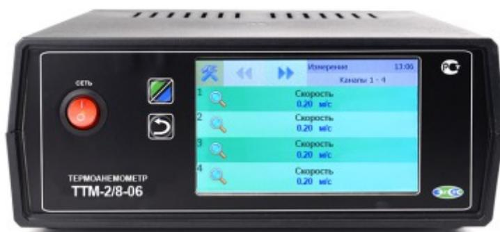
Передняя панель измерительного блока (8 каналов). Сенсорный TFT-дисплей 5"
