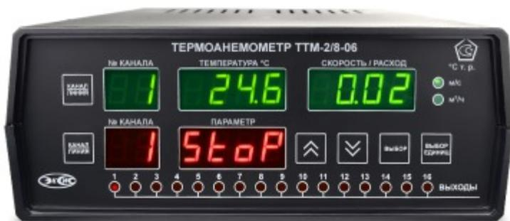
Передняя панель измерительного блока (8-16 каналов). Светодиодная индикация.
