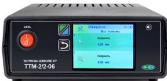
Передняя панель измерительного блока (1-4 канала). Сенсорный TFT-дисплей 3"
