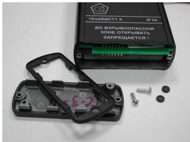
Рисунок 3 Снятие задней крышки
