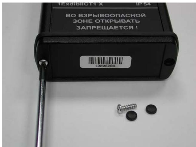
Рисунок 2 Вывинчивание винтов
