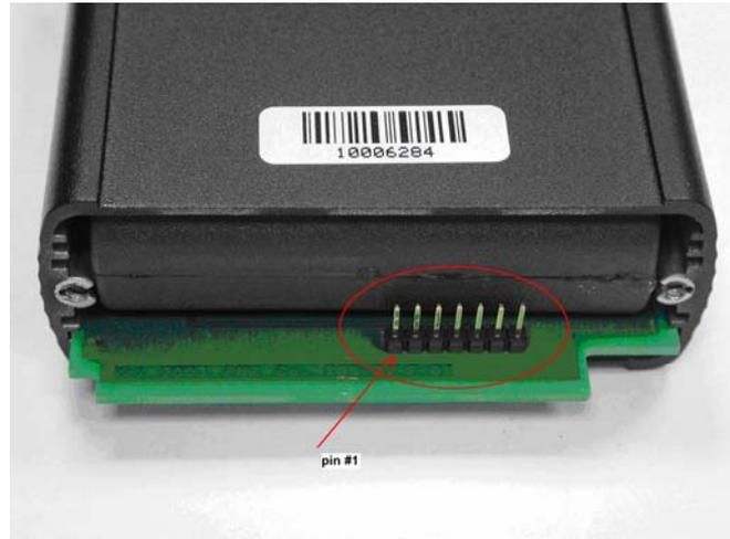
Рисунок 4 Разъем для подключения ПИ-3
