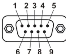
Рисунок 3.5 Разъем подключения к компьютеру по RS-232
