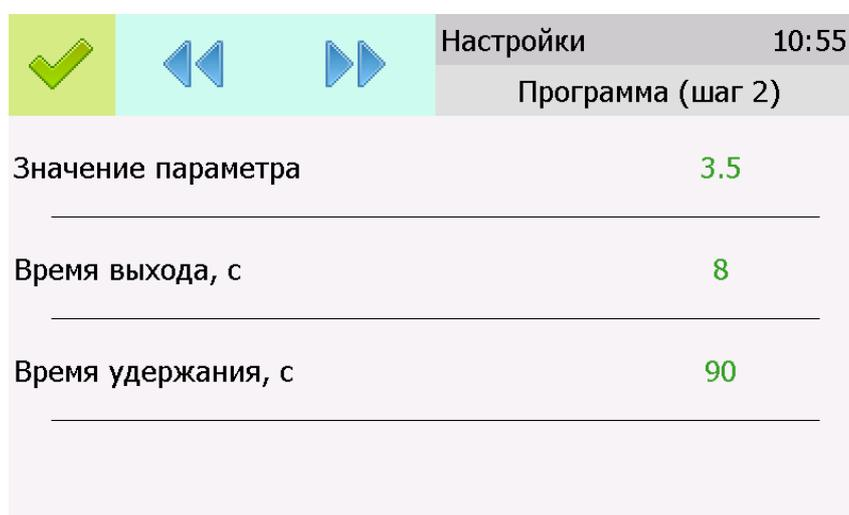
Рисунок 6.32 Вид экрана настройки второго шага программы регулирования
