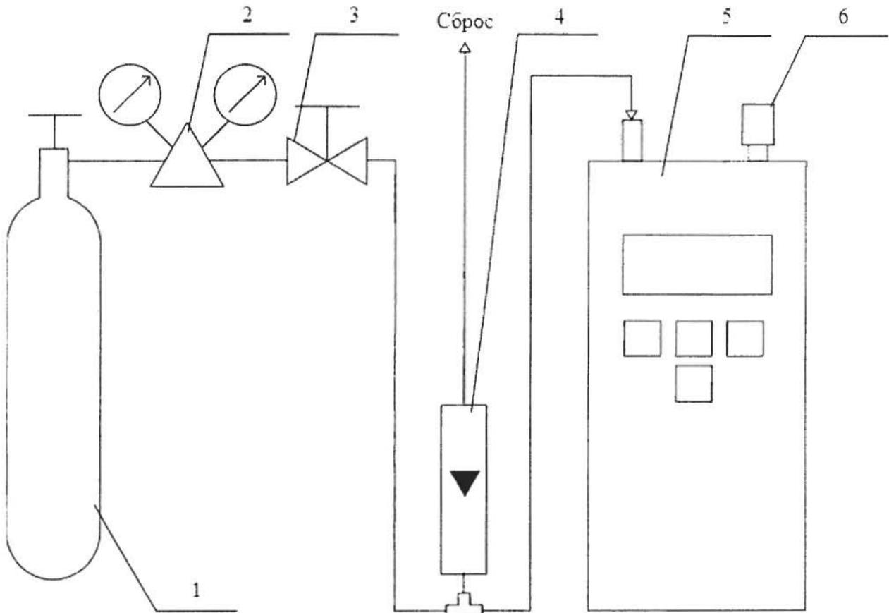
1 – баллон с ГС; 2 – редуктор баллонный; 3 – вентиль точной регулировки трассовой; 4 – ротаметр (индикатор расхода); 5 – поверяемый газоанализатор (показан условно); 6 – заглушка штуцера «выход» (только для ПКГ-4 В-К-П, ПКГ-4 В-СО-П).
