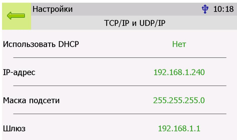
Рисунок 6.38 Экран настройки TCP/IP
