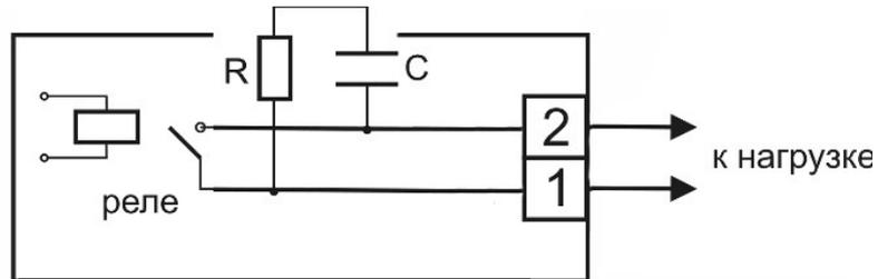
Рисунок 3.8 Подключение нагрузки к выходу управления
