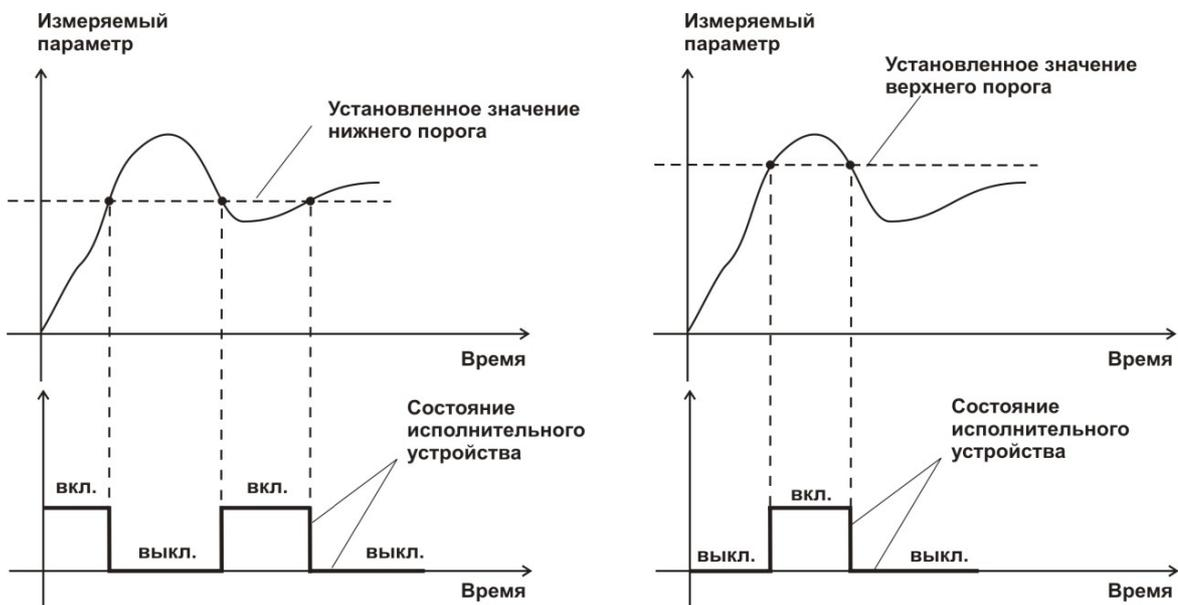
Рисунок 3.11 События: нарушения НП (слева), нарушение ВП (справа)
