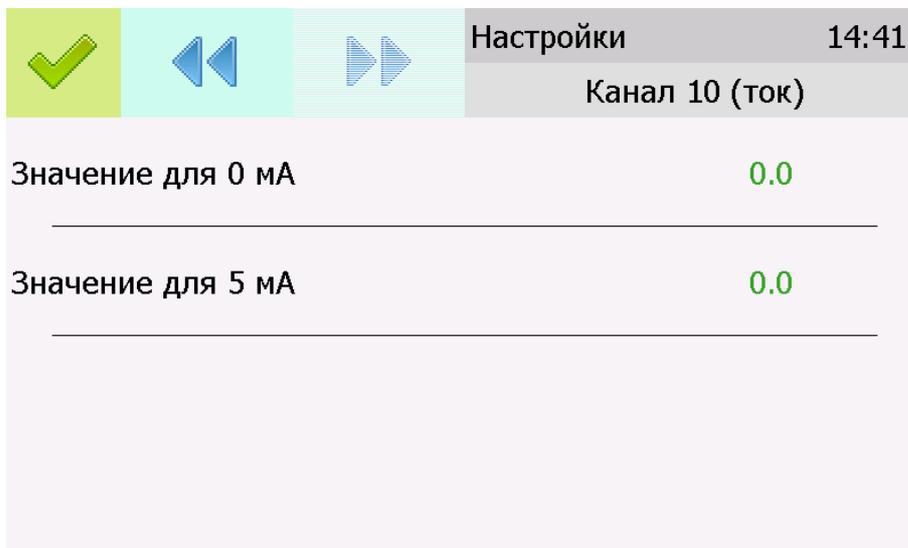
Рисунок 6.35 Вид экрана настройки линейного токового выхода 0...5 мА.
