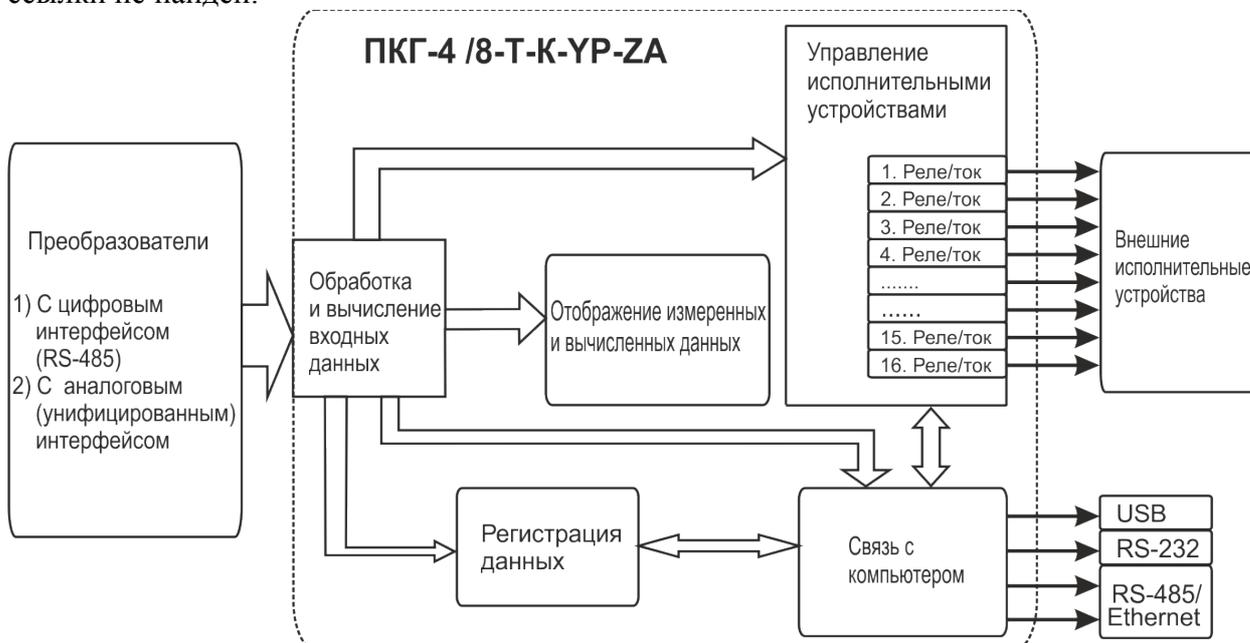
Рисунок 3.10 Функционирование газоанализатора
