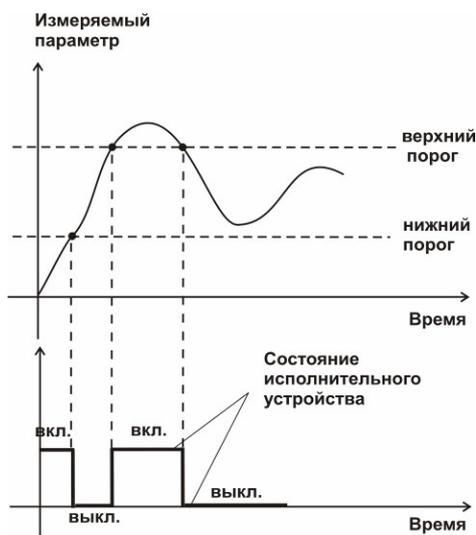
Рисунок 3.12 Функция вида  $f = \text{НП} + \text{ВП}$
