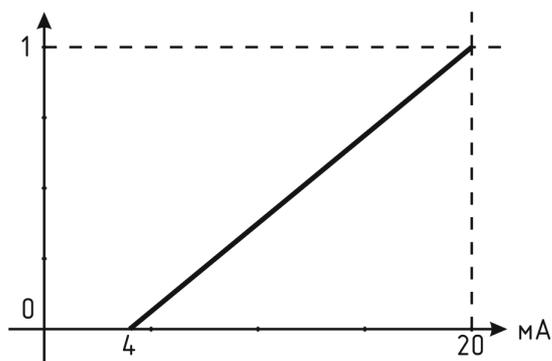
Рисунок 3.14 Линейный выход 4...20 мА с диапазоном 0...1%
