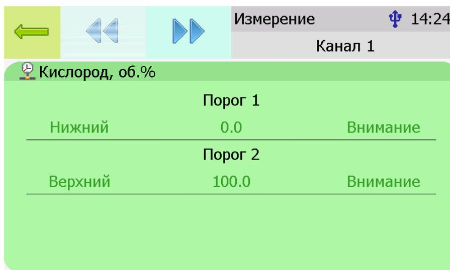
Рисунок 6.20 Экран настройки пороговых значений второго канала
