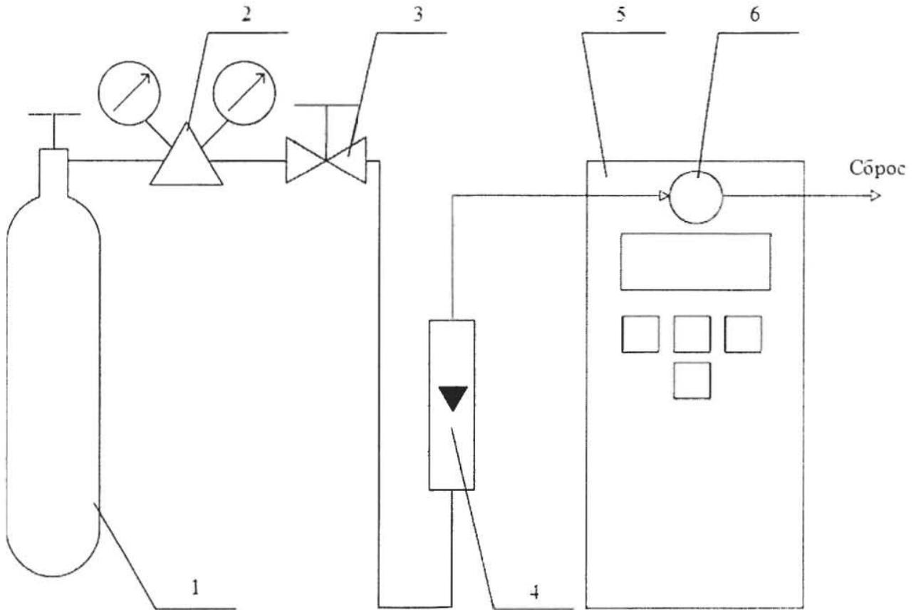
1 – баллон с ГС; 2 – редуктор баллонный; 3 – вентиль точной регулировки трассовый; 4 – ротаметр (индикатор расхода); 5 – поверяемый газоанализатор (показан условно); 6 – насадка для подачи ГС
