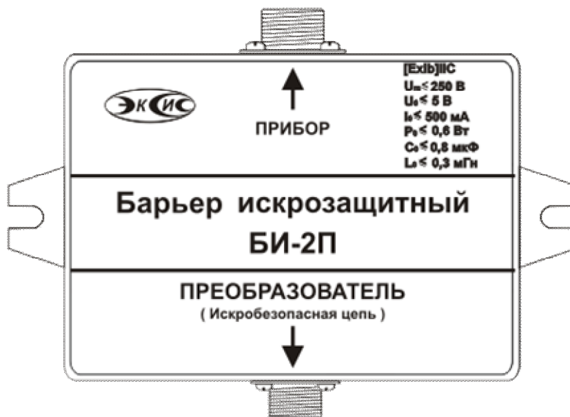
Рисунок 3.15 Барьер искрозащиты БИ-2П
