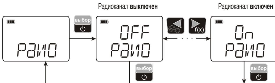
Рисунок 5.4 Включение\выключение радиоканала.
