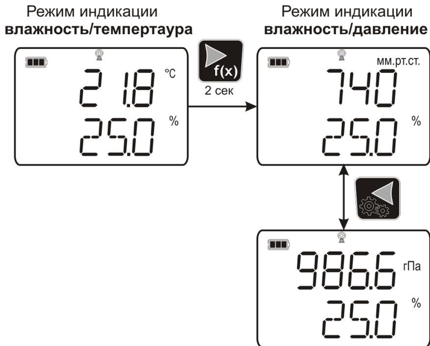
Рисунок 5.2 Переключение режимов индикации ИВТМ-7 М 4-Д-02
