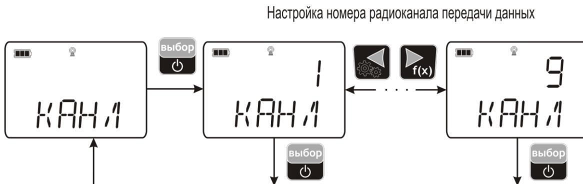
Рисунок 5.5 Установка номера радиоканала для передачи данных.
