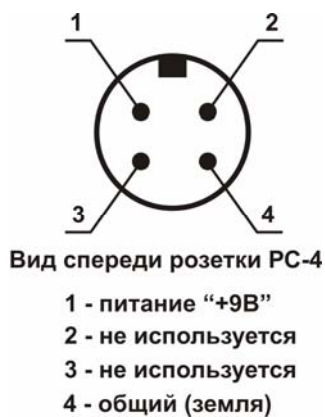
Рисунок 7 Назначение контактов разъема блока питания ТФАП. 563541.004
