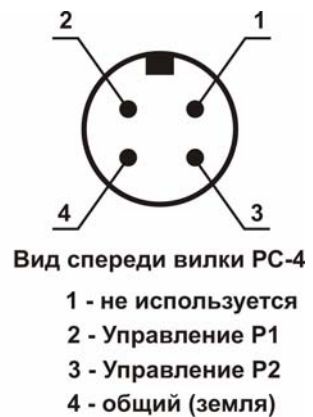
Рисунок 8 Назначение контактов разъемов блока питания ТФАП. 563541.005
