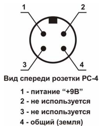
Рисунок 8 Назначение контактов разъемов блока питания ТФАП. 563541.005
