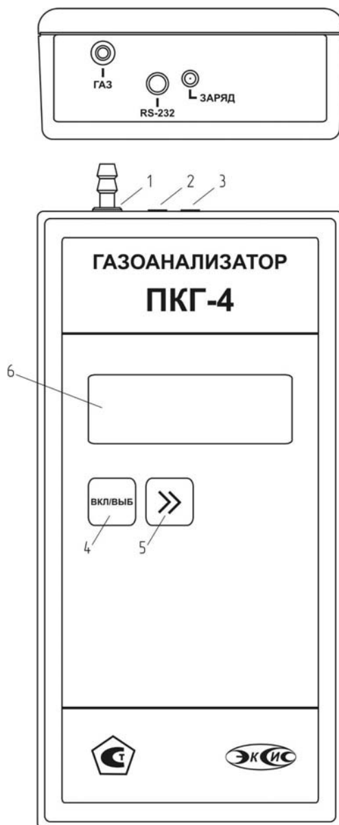
Рисунок 3.1 Вид передней панели прибора
